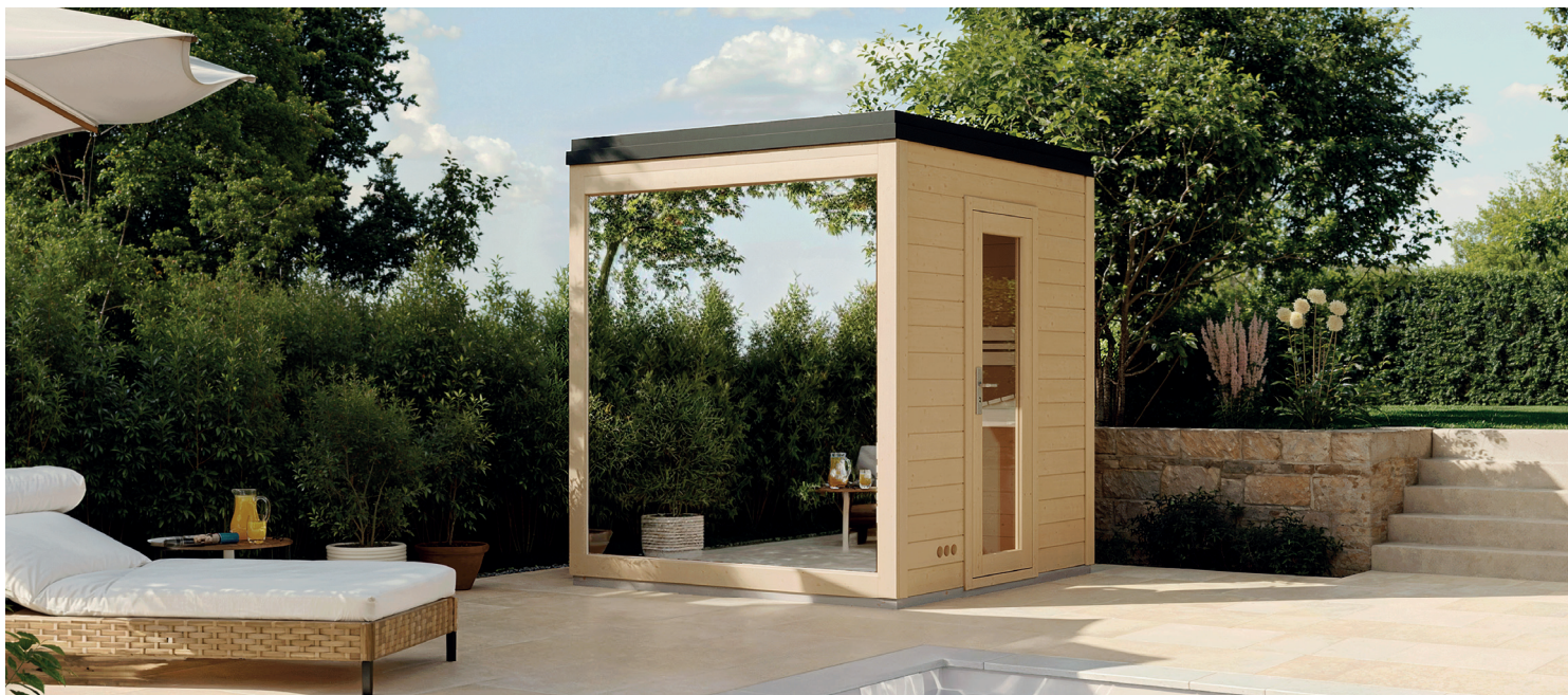
Abb.: Gartensauna CASA 1 mit Sonderausstattung: Panoramafenster verspiegelt, Attika aus Blech in anthrazit, selbstklebende Dachbahn „BYTUM SLATE 3500“ mit Schieferbeschichtung, Regenrinne mit Ablauf, Saunasteuerung T innenliegend, Saunaofen Ferro.
